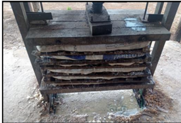
Figura 6: Prensagem da massa de mandioca lavada
