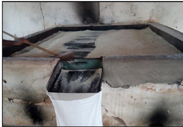
Figura 8: Processo de torração da massa
