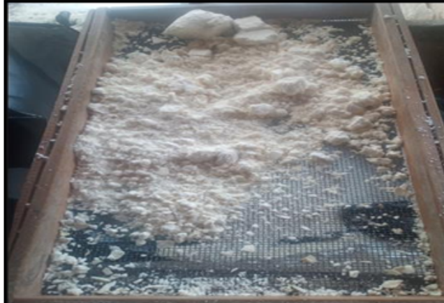
Figura 7: Processo de peneiração da massa
